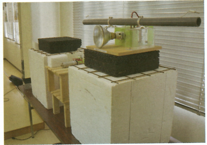
高周波電流により床から電気が供給されるしくみ
